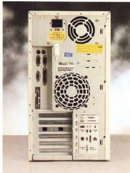
Fronte e retro. Notare posteriormente la seconda ventola di aerazione e lo schema dei connettori.
